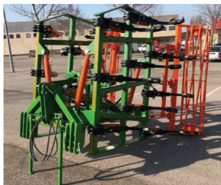
Posibilidad de estacionamiento plegado con dos apoyos delanteros
