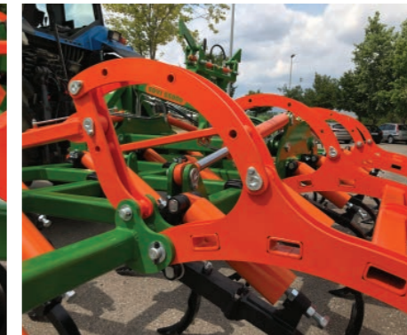
Sistema ControlRoll con fácil ajuste por la parte delantera y reparto de esfuerzos a todo el chasis
