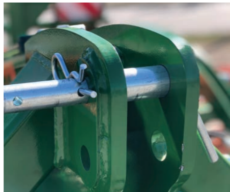
Doble enganche Cat. II i Cat. III en los brazos inferiores y al tercer punto
