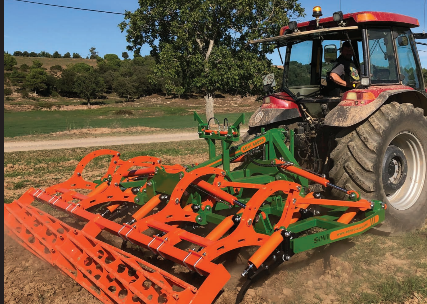
Sistema de seguridad con doble cilindro hidráulico
