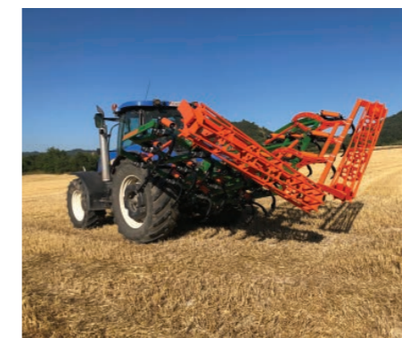
Plegado hidráulico vertical en dos partes
