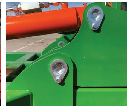
Pasadores fijados con tornillo para evitar rotación
