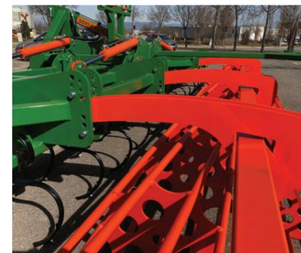
Fácil ajuste de altura del rodillo con doble pasador
