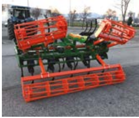
Plegado hidráulico lateralmente con un cilindro hidráulico por cada lado
