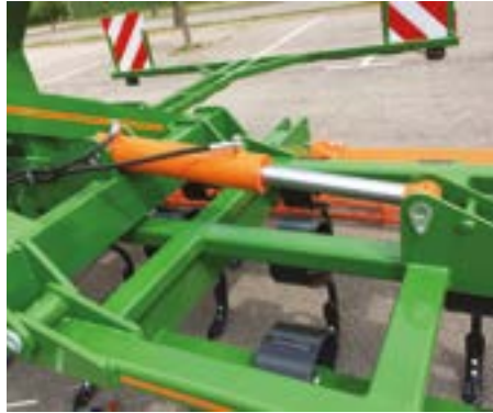
Cilindros de gran capacidad de 100 mm de diámetro
