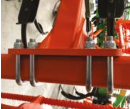
4 abarcones en cada brazo del rodillo
