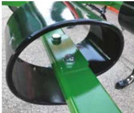
Pieza superior para reforzar el amarre del brazo para todos los modelos
