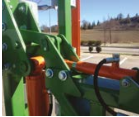
Plegado con sistema de seguridad mediante doble cilindro hidráulico
