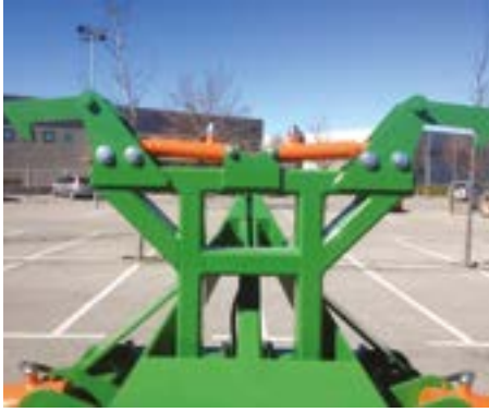
Plegado con sistema de seguridad mediante doble cilindro hidráulico
