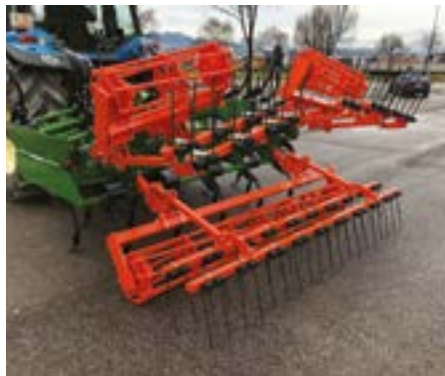
Rastrilla posterior desmontable y ajustable en altura
