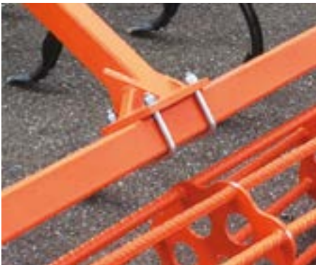
Doble abarcón para sujetar el rodillo
