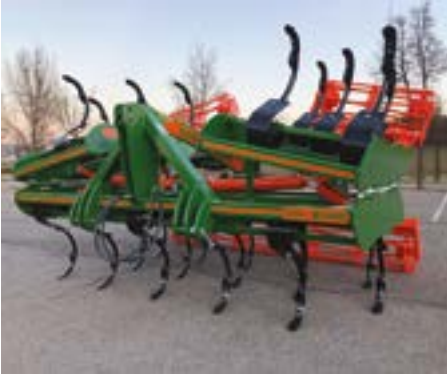
Plegado hidráulico lateralmente con un cilindro hidráulico por cada lado
