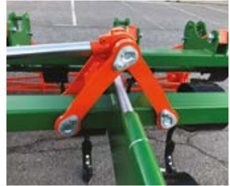
Bulones de gran diámetro fijados con tornillo
