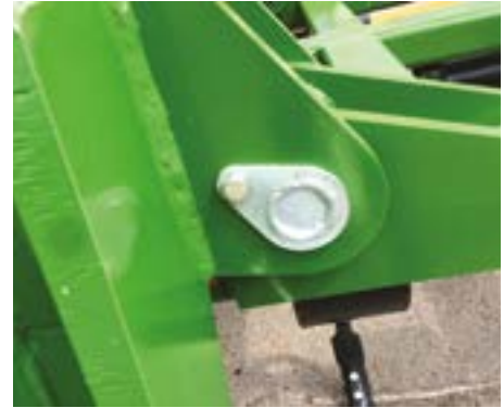
Pasadores fijados con tornillo para evitar desgaste
