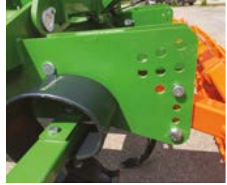
Ajuste de altura del rodillo con varios agujeros
